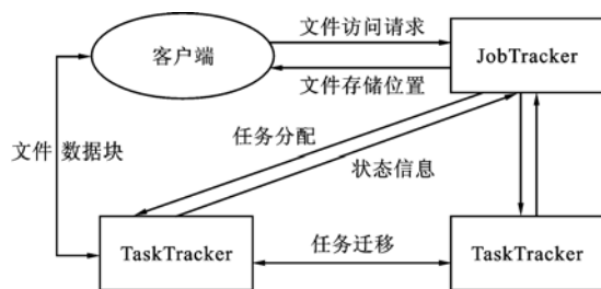
图1 MapReduce 多组容错技术结构关系图
